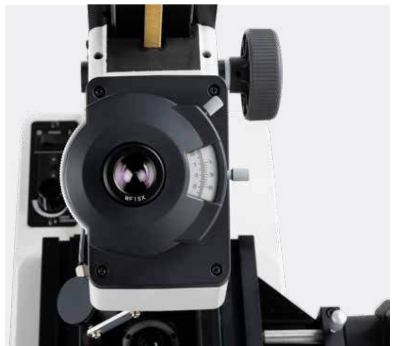
Un goniometro montato all'esterno dell'oculare consente una semplice misura dell'angolo.
