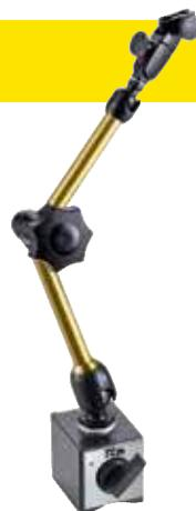
Base magnetica disinseribile mediante chiaffetta, superficie d'appoggio con sagoma a V che consente ancoraggi anche su superfici curve, aste di colore giallo con snodi, chiusura meccanica centrale, attacco universale con regolazione fine.
