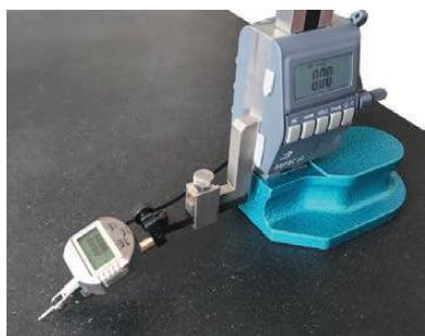
\* **1550902** Tastatore digitale per stabilizzazione automatica della lettura a display del truschino.
