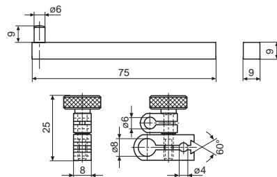
**2341311** Attacco per comparatore o tastatore.
