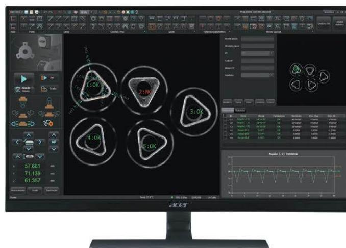
L'innovativo programma di misura **"VisionX Pro"** permette in pochi click di acquisire elementi geometrici tramite **analisi di immagine** e di creare programmi di misura in grado di **eseguire misurazioni automatiche** su pezzi non allineati **premendo un solo pulsante**.
