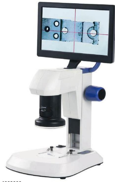
Ispezione visiva diretta a monitor con software di misura integrato.
