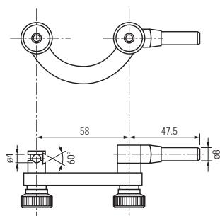
**2349999** Supporto di centralaggio per tastatore.
