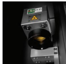
ASSE Z MOTORIZZATO CON PROTEZIONE
