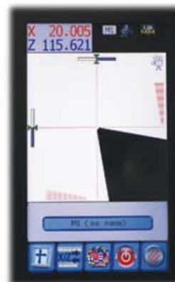
Collimazione del profilo utensile su reticolo fisso con comparatori analogici asse X e Z: barre di controlli degli assi per l'esatta posizione centrale della misura.
