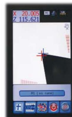
Misura del tagliente in automatico. Trovata la posizione centrale per mezzo delle barre di messa a fuoco, sui contatori assi viene visualizzata la misura senza ulteriori manovre.
