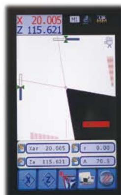
Nella misura in autocollimazione, gli enti geometrici del profilo visualizzato sono rilevati in modo automatico. I valori di raggi, angoli, asse X e asse Z possono essere memorizzati e/o stampati su etichetta.
