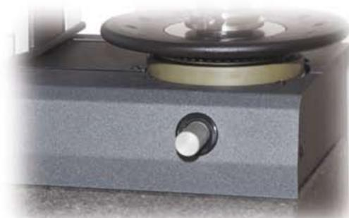
Il freno della rotazione mandrino è provvisto di una frizione tarabile.
